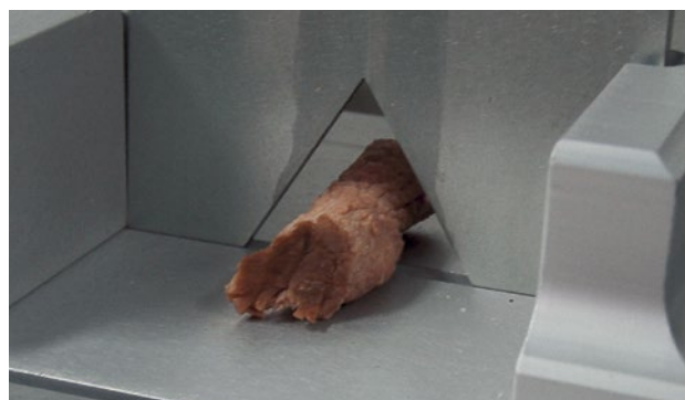
Figure 2 | Analyse de la force de cisaillement de la viande d'agneau (indicateur de tendreté) en laboratoire. (Photo: Helen Willems)
